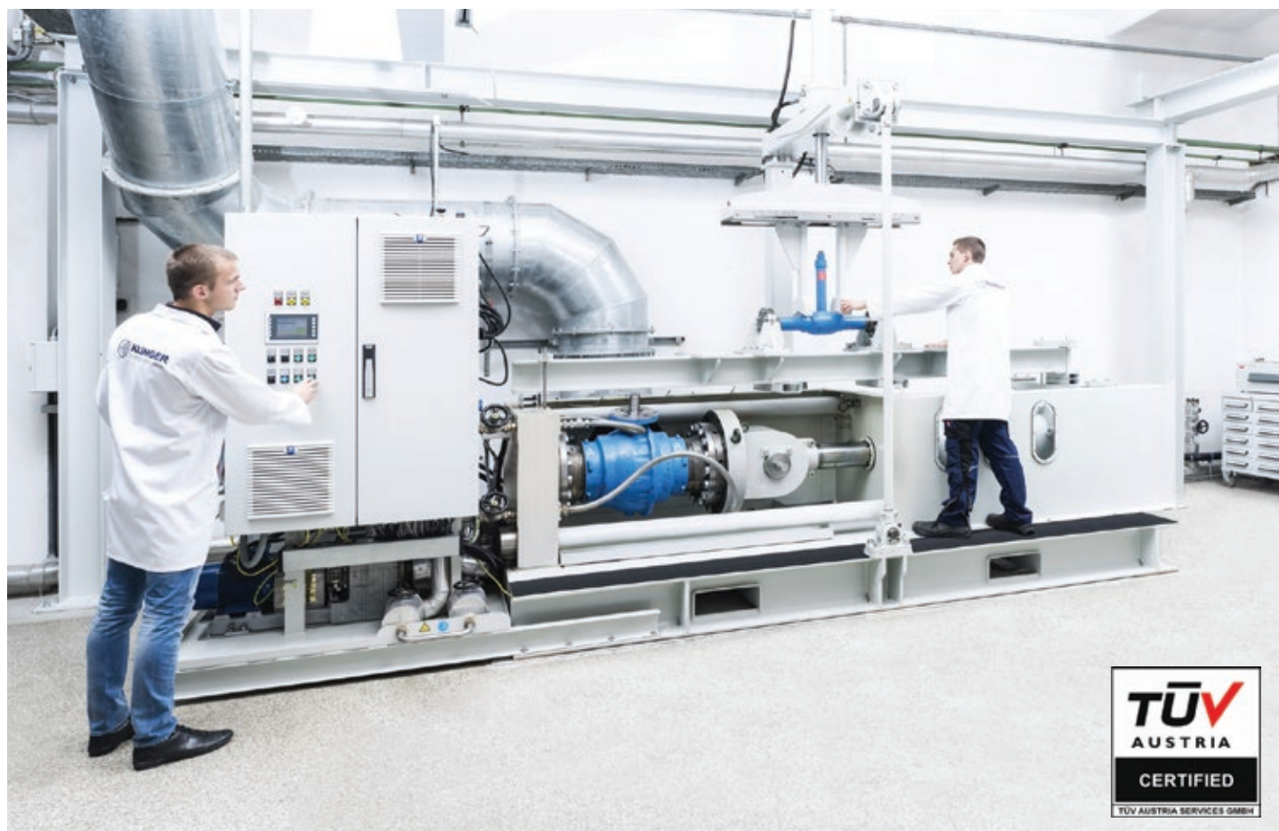
Den testanläggning som används i KLINGERS fabrik för att testa ventilerna enligt EN 488:2015 har certifierats av TÜV Austria.
