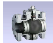
Metalltätande Dubbelt lagrad kula "Trunnion" Dubbla fjäderbelastade tätningsringar mot kulan.
